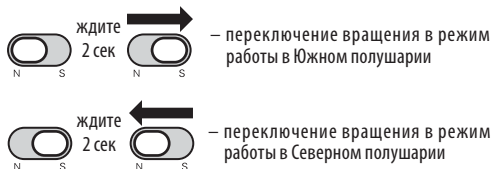
[рис. 4] настройка Прибора по широте
